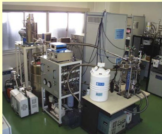
図1 液体ヘリウム再凝縮式・連続流型冷却装置と極低温電気物性測定装置
